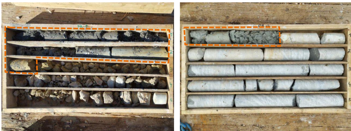
Slika 1. Prikaz naslaga marinskih sedimenata u sklopu bušotine PB-1 (slika lijevo) do PB-4 (slika desno)
