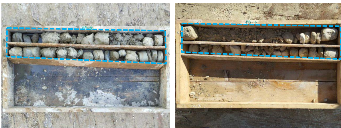
Slika 3. Prikaz stijenske mase laporovitih vapnenaca u sklopu bušotine B-2 (slika lijevo) i B-6 (slika desno)
