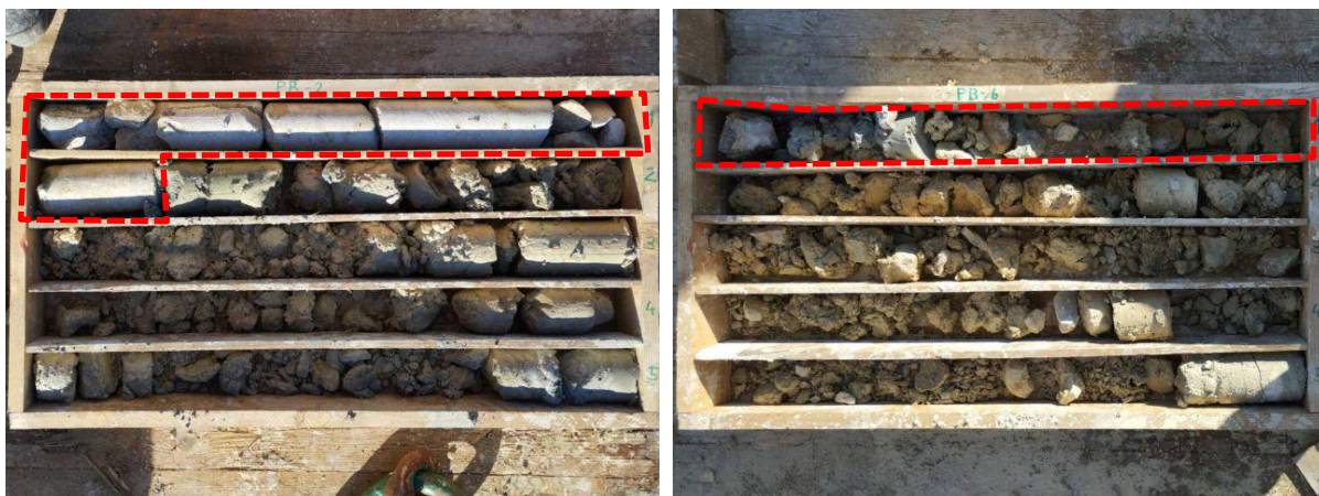
Slika 6. Prikaz naslaga nabačaja (betonski blok) u sklopu bušotine PB-2 (slika lijevo) i PB-6 (slika desno)
