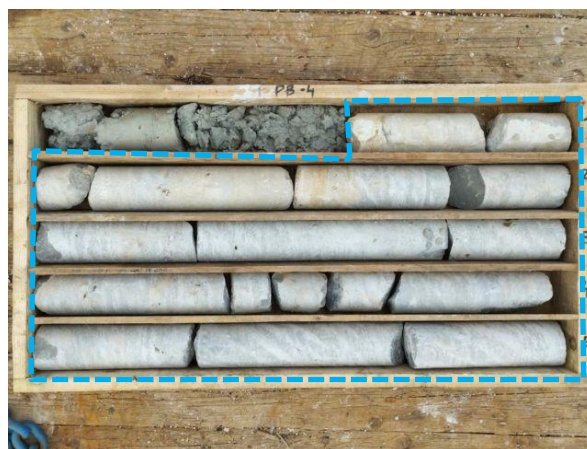
Slika 4. Prikaz stijenske mase laporovitih vapnenaca u sklopu bušotine B-1 (slika lijevo) i B-4 (slika desno)
