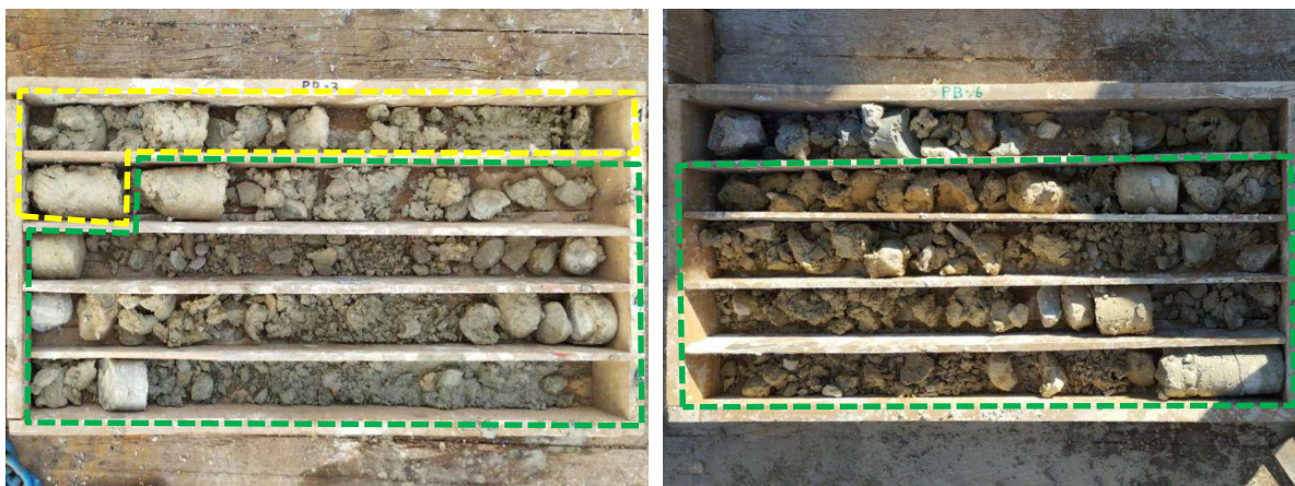
Slika 2. Prikaz naslaga lapora u sklopu bušotina PB-3 i PB-6; potpuno trošni lapori (žuta oznaka), visoko trošni lapori (zelena oznaka)
