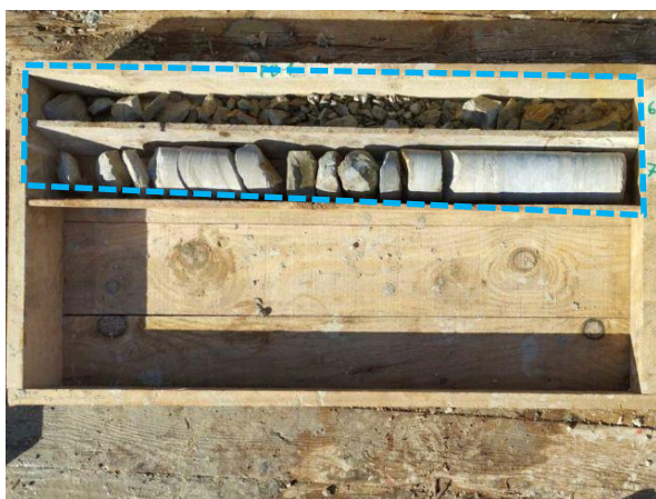
Slika 4. Prikaz stijenske mase laporovitih vapnenaca u sklopu bušotine B-1 (slika lijevo) i B-4 (slika desno)
